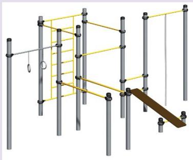
менее 1000 мм. Стойка комплекса должна быть изготовлена из стальной трубы диаметром не менее 108 мм с толщиной стенки не менее 3 мм. Верхние торцы стоек закрыты антивандальными заглушками высотой не менее 5 мм.
