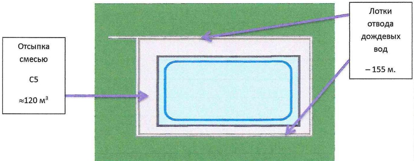
В состав щебеночно-песчаной смеси С5 должны входить гранитный щебень и карьерный песок. Максимальный размер гранулометрического состава 80 мм. Основной объем должны составлять зерна 40-60 мм. Объем пылевидных и глинистых включений не превышать 4% и отвечать установленным стандартам ГОСТа 25607-94.
